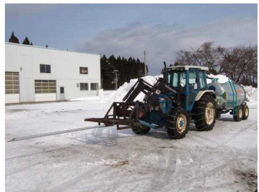
写真4 1年目ST区瞬間送気機全貌
