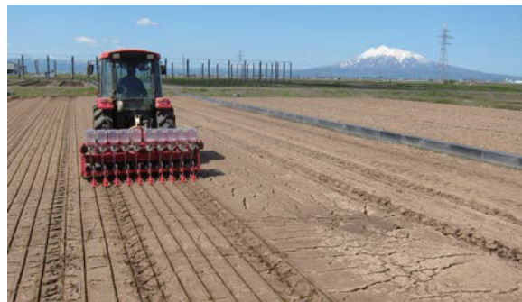
水稻V溝播種機での播種作業
