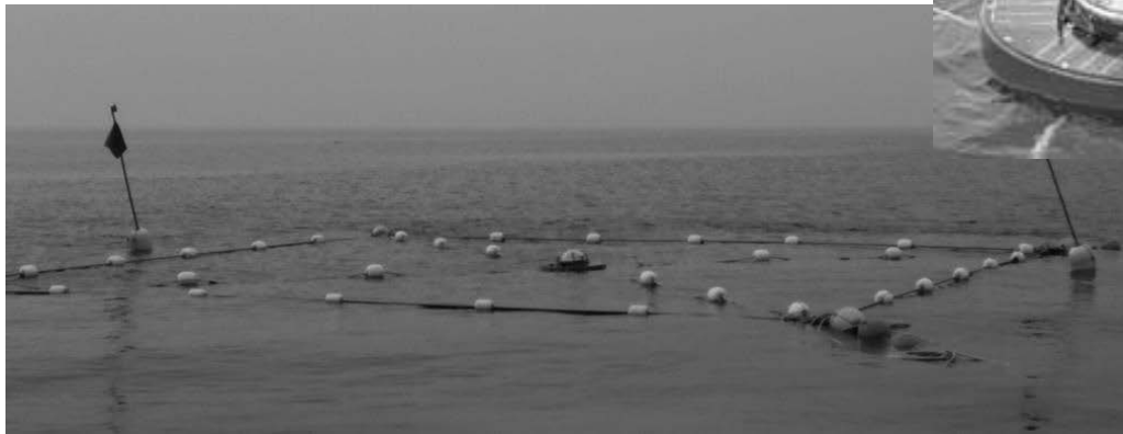
図2 ブイ式波高計の設置状況
