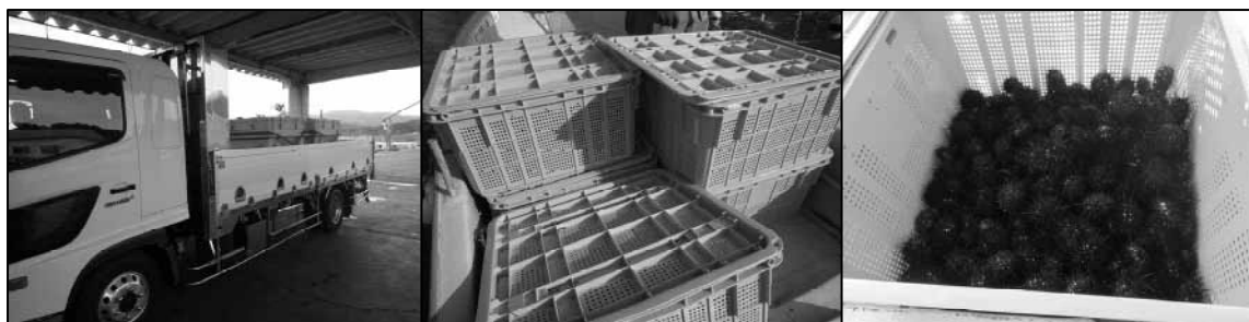
写真1 蓋付きプラスチックコンテナを用いた輸送方法
