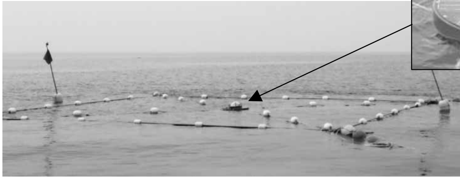
図2 ブイ式波高計の設置状況
