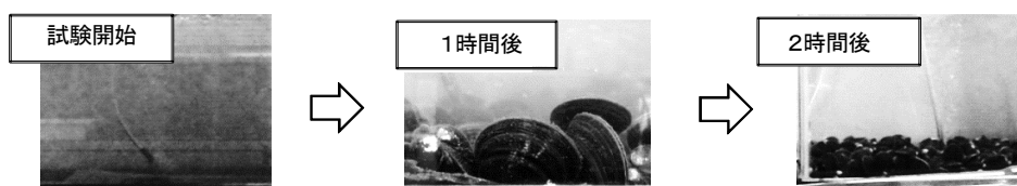
写真1 シジミ浮遊懸濁物除去試験における透明度の変化
