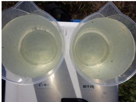
図2 採水サンプル（左：ビーカー、右：試作採水器）
