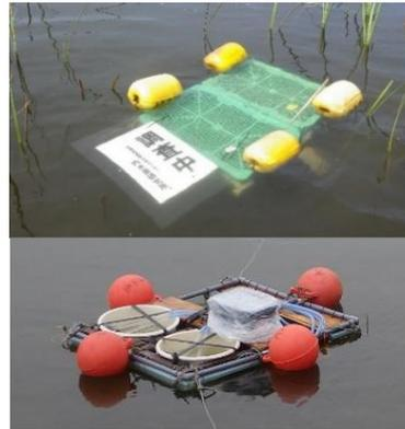
図2. 試験に使用した浮きカゴ（上）とイカダ（下）
