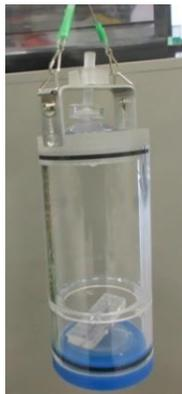
図1 試作採水器
