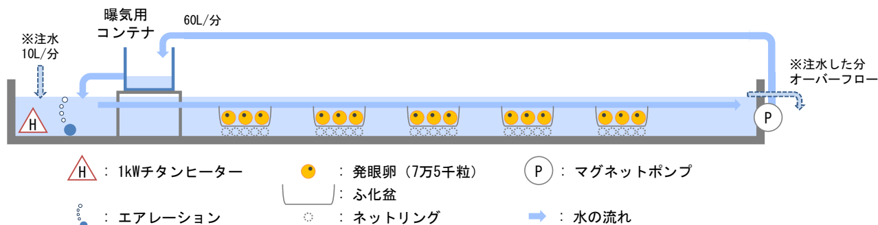
図1. 老部川サケふ化場における半循環型サケ仔魚管理システム概要
