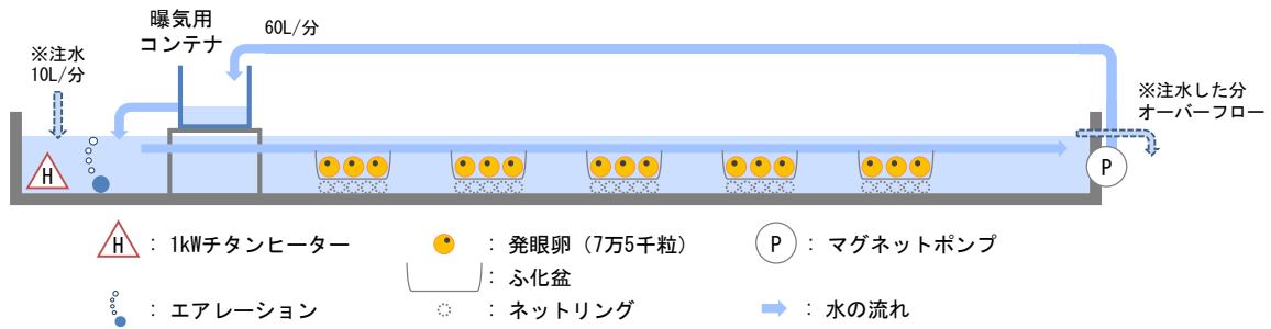
図1. 老部川ふ化場における半循環型サケ仔魚管理システム概要
