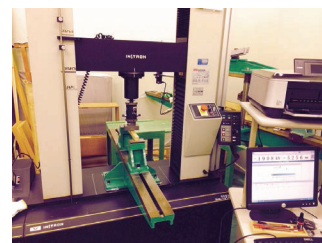
photo: JIS(日本工業規格)に基づく木材試験
