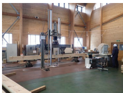
photo: 木材の曲げ強度試験
