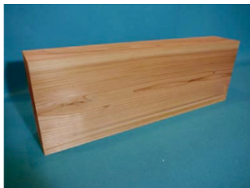
図1 割れの無い乾燥材製品 注) 心持ち材は、乾燥時に割れやすい
