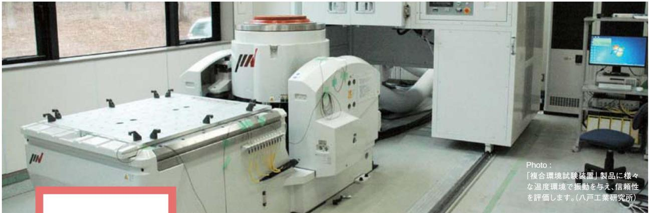
Photo : 「複合環境試験装置」製品に様々な温度環境で振動を与え、信頼性を評価します。(八戸工業研究所)
