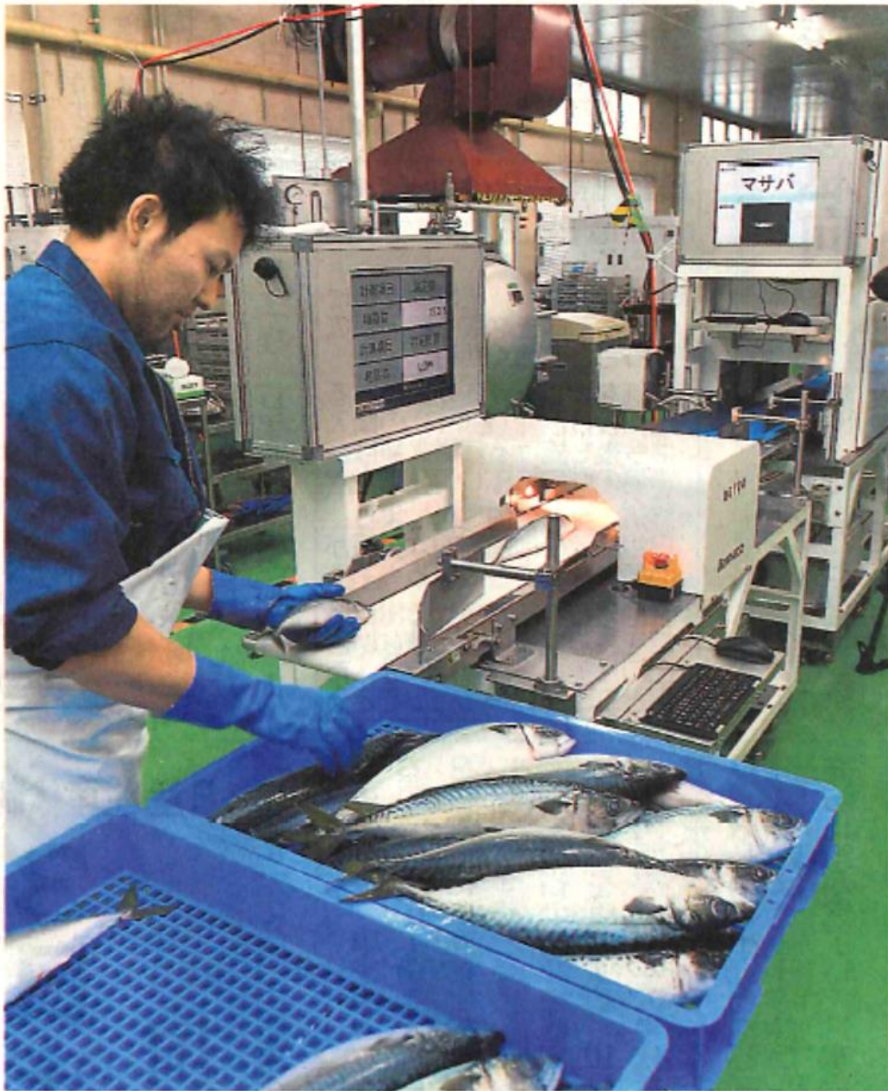
魚体の粗脂肪率と、マサバかゴマサバの判別を一つのラインで自動選別する装置。結果は中央部と右奥のモニターに表示される
