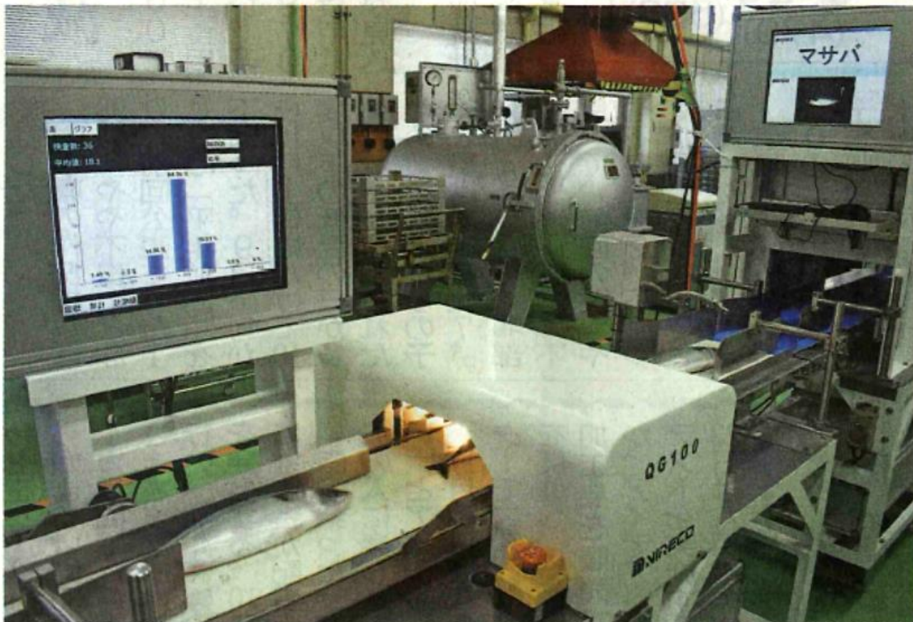
青森県産業技術センター・食品総合研究所が開発したサバの計測装置＝31日、八戸市の同研究所
