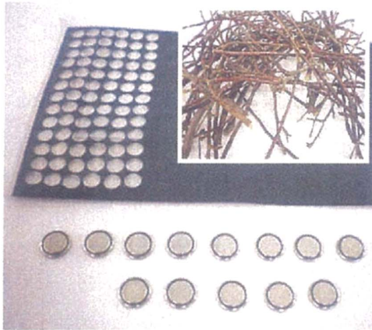
リンゴ剪定枝（写真右上）と試作コンデンサー
