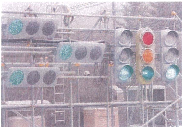
LED信号機着雪・凍結対策評価システムでの試験
