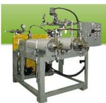
オンローター<br/>（境膜掻取式熱交換反応機）
