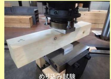
実大サイズの試験体に荷重を加えて試験をしています。
