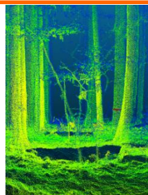
レーザーの点群
