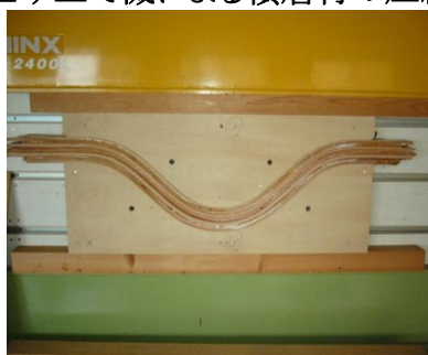
組み立て機による積層材の圧縮
