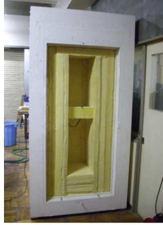
簡易遮音性能試験装置の内部と試験風景
