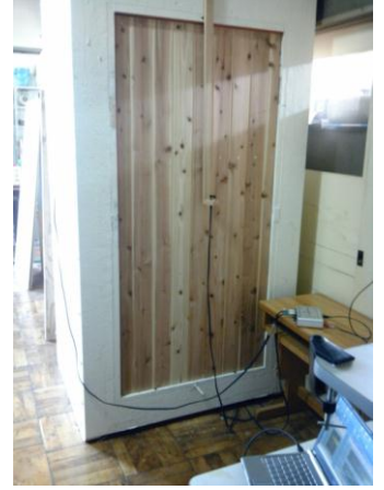
簡易遮音性能試験装置の内部と試験風景
