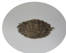
水分10%以下に乾燥 ミキサーで粒度10mm以下に
