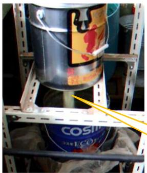
底に穴を空けてフロート弁を設置
