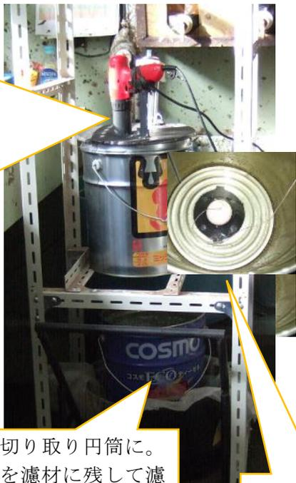
底板を切り取り円筒に。凝固部を濾材に残して濾過器を引き抜く方式で作業が楽に。
