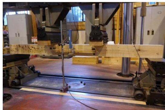
図-55 実大曲げ試験 (枯死材)
