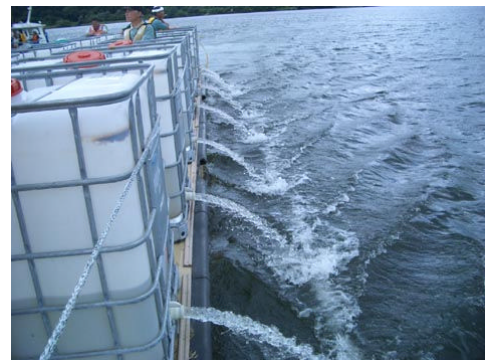
図 17 1トン水槽から湖へ直接放流
