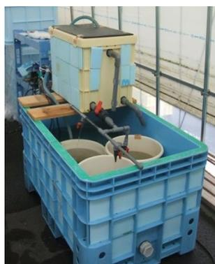
図3. 閉鎖循環飼育水槽
