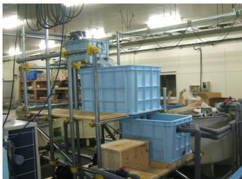
図3 閉鎖循環システムの3段型濾過槽
