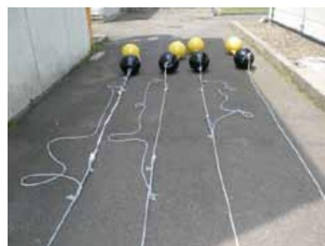
写真2 試験に用いた調整玉（左からゴム2m×2本、ゴム2m×1本、ゴム1m×1本式の改良調整玉、従来式の調整玉）
