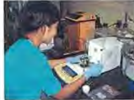
水分測定のため、試料を秤量しているところ。
