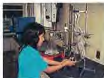
粗タンパク質測定のため分解をしているところ。
