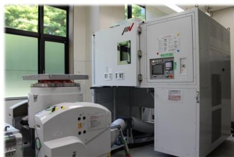
複合環境試験装置(八戸工業研究所)
