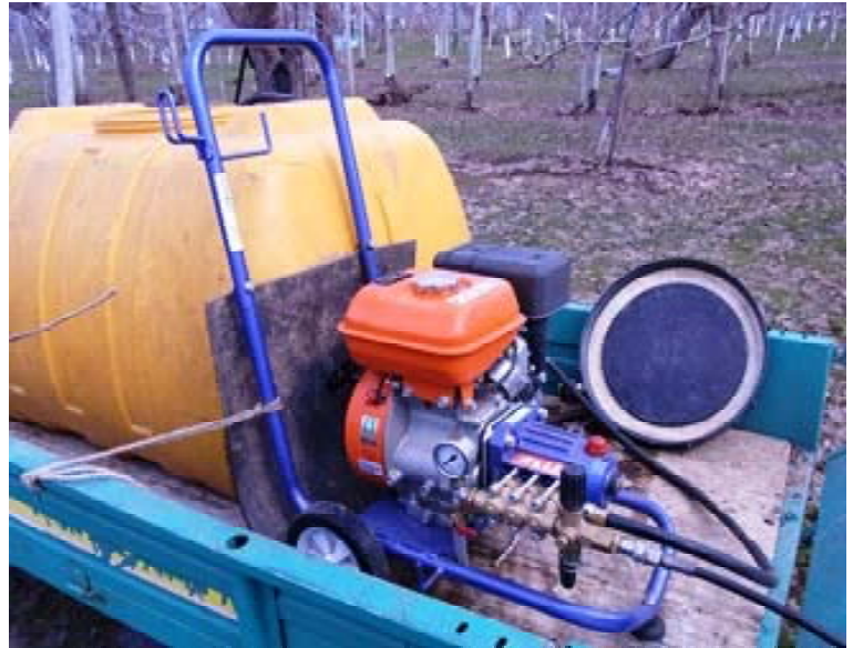
写真3 運搬車に乗せた高圧洗浄機(試験の供試機)と水タンク (本機: WH1511/BS(共立製作所) 価格; 133,560円、税込み)
