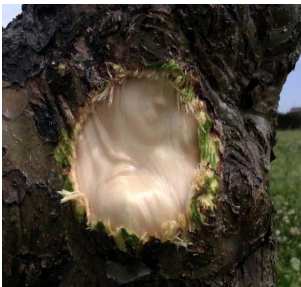
圧力15MPa20cm (削り過ぎ 木質部露出; ××)
