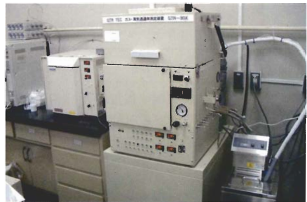
ガス透過率・透湿度測定装置 GTR-30X (GTR テック株式会社製)
