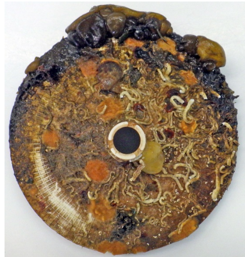
図20. 浜奥内漁港のクペールに付着した付着生物
