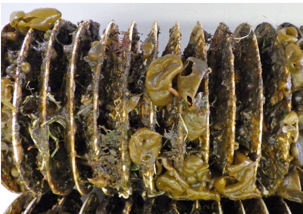
図20. 浜奥内漁港のクペールに付着した付着生物
