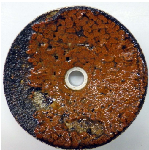
図21. 横浜漁港のクペールに付着した付着生物
