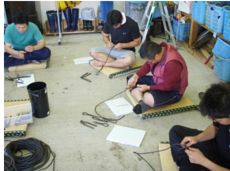
ロープワーク（三打ちロープさつま加工）
