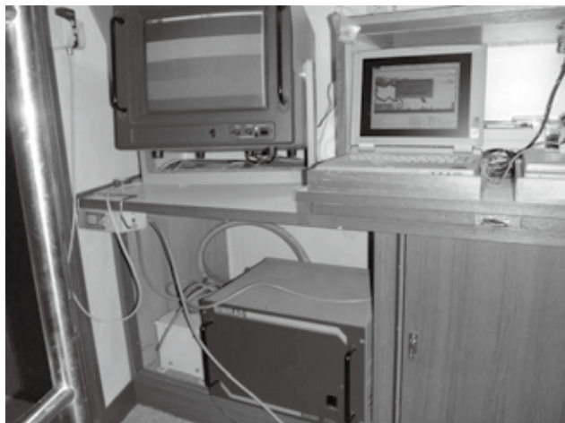
図 1. 計量魚群探知機（SIMRAD EK500, 38kHz）
