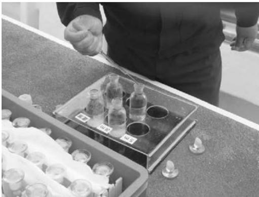
図7 溶存酸素測定のための処理
