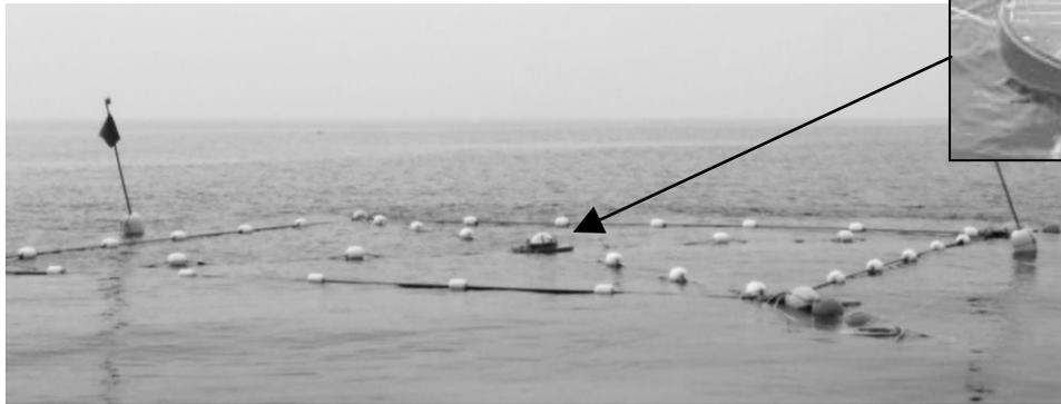
図2 ブイ式波高計の設置状況
