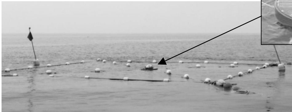
図2 ブイ式波高計の設置状況
