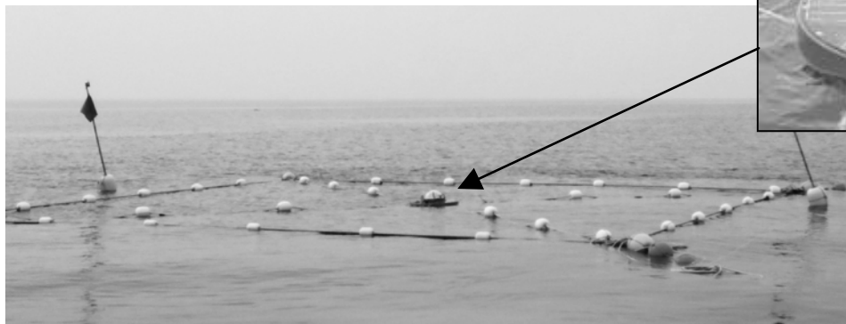
図2 ブイ式波高計の設置状況
