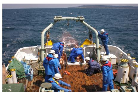
試験船青鵬丸でのトロール網の投入状況
