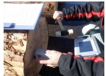
簡易強度測定器で丸太を測定している状況
