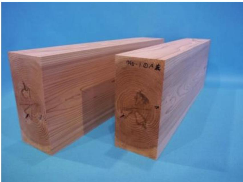
乾燥試験で作成した割れのないスギ平角材
