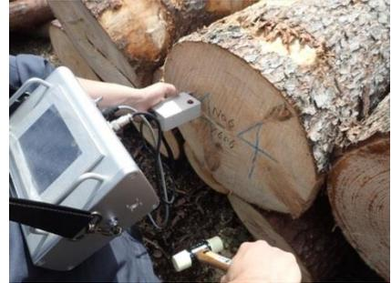
簡易強度測定器（エーティーエー社製の「簡易型原木強度検査器HG-2020」）
