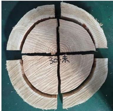
丸太から採取した円盤（心材と辺材に分割して含水率を測定）
