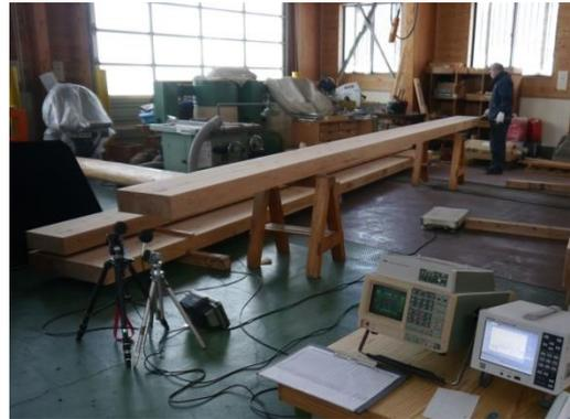
仕上がり材の測定（縦振動法）
