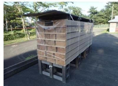
屋外に栈積みし、天然乾燥を行っている様子。雨よけの屋根を乗せ、高床状にし、ビニルで側面を囲って雨よけと下からの熱の対流を促す工夫をしている。
