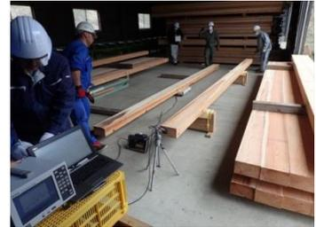
縦振動法で測定している状況
