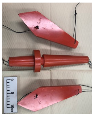
図1 表層用曳釣漁具写真。 上段が潮切りヒコーキ（左舷用）、中段がダンプ、下段が潮切りヒコーキ（右舷用）。
