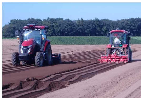
実演会：2台のトラクタの協調作業 右：自動操舵トラクタ（有人） 左：ロボットトラクタ（無人）
