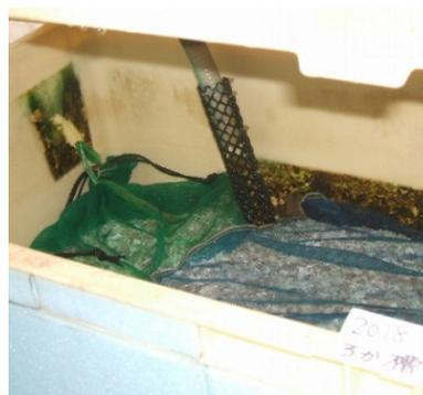
写真8 給水ホース先端部をろ材の間に埋め込む
