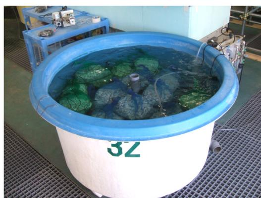
写真 熟成中のろ材(1トン水槽)
