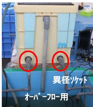
写真 4 異径ソケットで径を落とす
