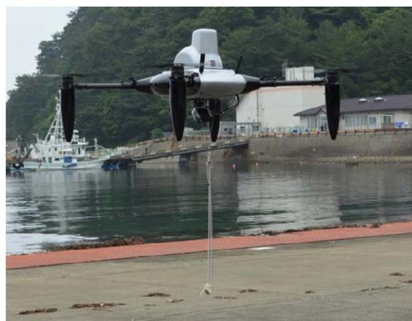
自記式水温計を吊り下げて飛行
