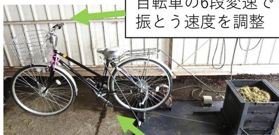
自転車の6段変速で振とう速度を調整
