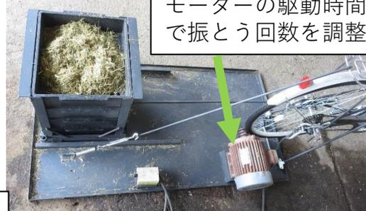
モーターの駆動時間で振とう回数を調整
