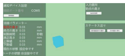
図2 トーチ動作矯正システム （上：システム概略、下：ソフトウェア画面）
