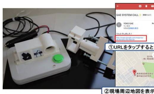
転倒通報システム(実証用試作機)
