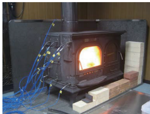
図1 燃焼試験の様子
