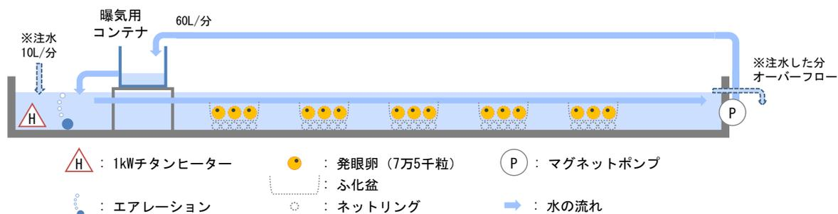
図1 試験水槽概要
