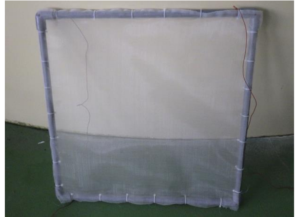
図 1. ふ化盆（枠 55 \times 55cm 目合 560 \mu m）
