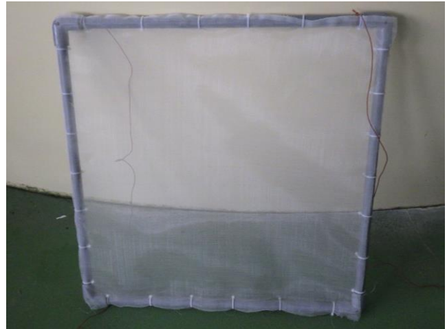
図1. ふ化盆(枠55 \times 55cm 目合560 \mu m)
